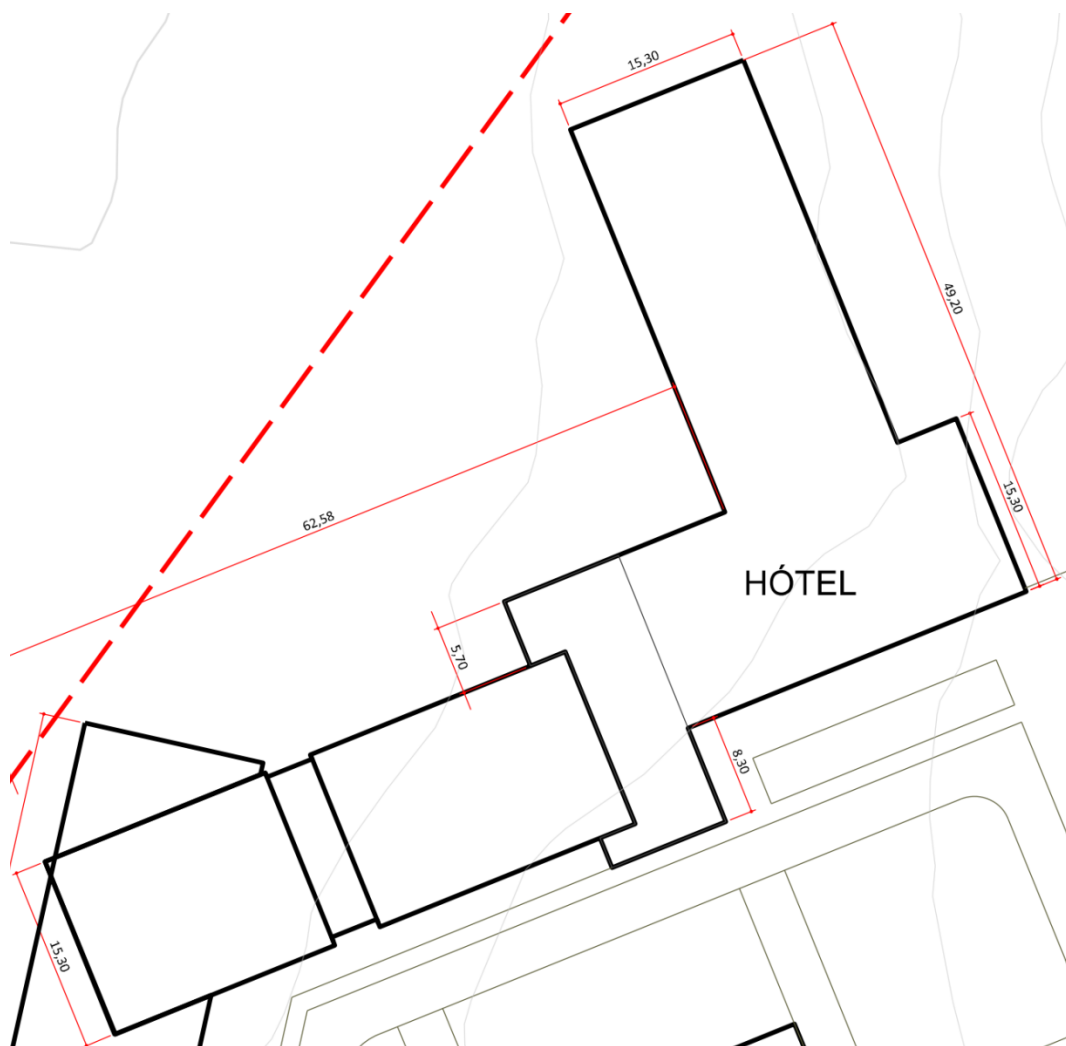
MYND 2.7 Hóтелиð verður L-laga með u.þ.b. 83 m og 50 m langar langhliðar. Ekki endanleg hönnun, einungis frumtillaga.
